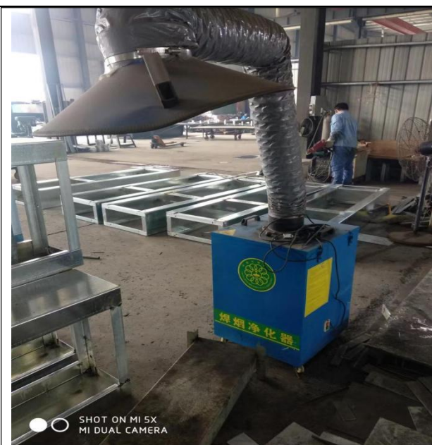
移动式烟尘净化装置
