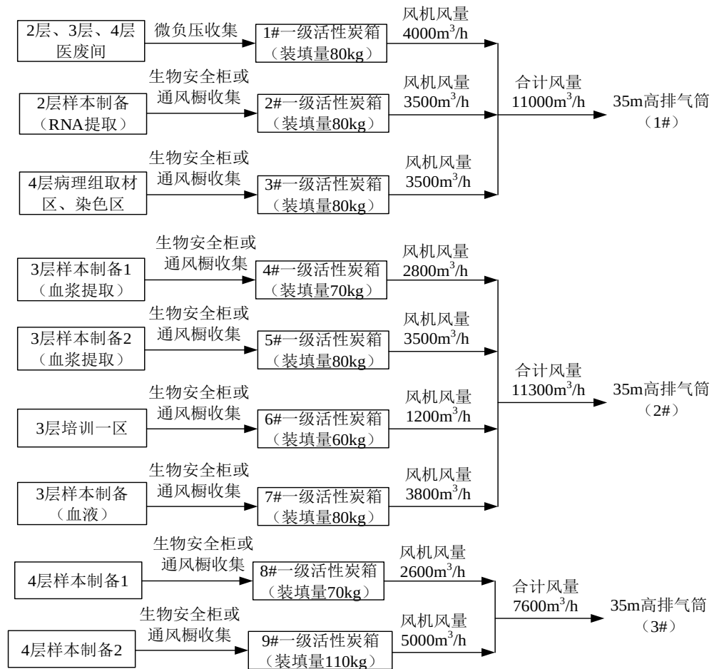
图 3.3-4 原环评中废气收集处理管道布置示意图
