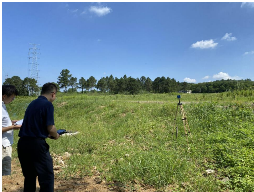
图 7-2 110kV 工频电场、工频磁场监测照片
