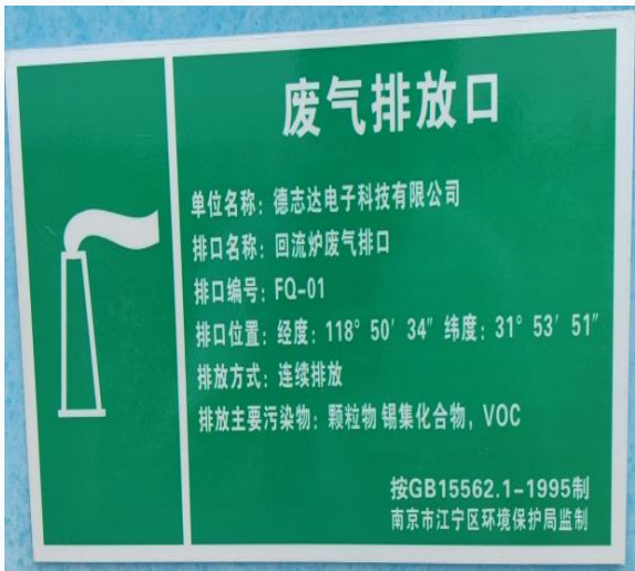
排气筒标识标牌（FQ-1）
