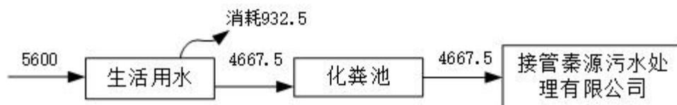
图 2-2 全厂水平衡图（单位：t/a）
