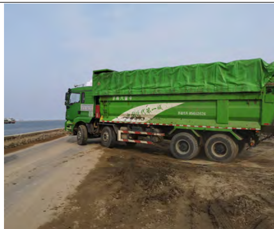
运输车辆覆盖防尘网
