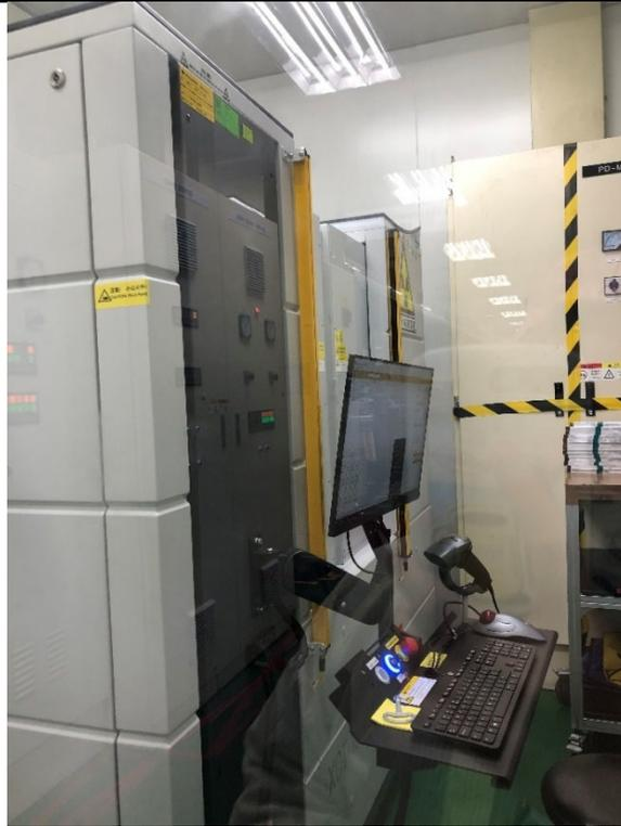
图 2-1 已购 Nordson XCT-1000L 型工业 CT 机实物图
