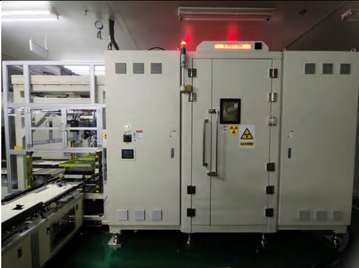
图 2-1 本项目 EVB-CTS AXI 型工业 CT 装置实物图
