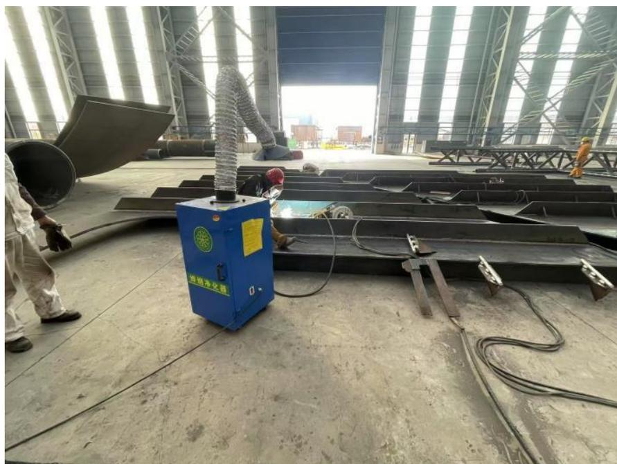
图 4.1-3 移动式焊接烟尘净化器
